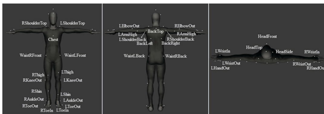
图 2-4 光学运动捕捉系统模型标记点位置示意图
